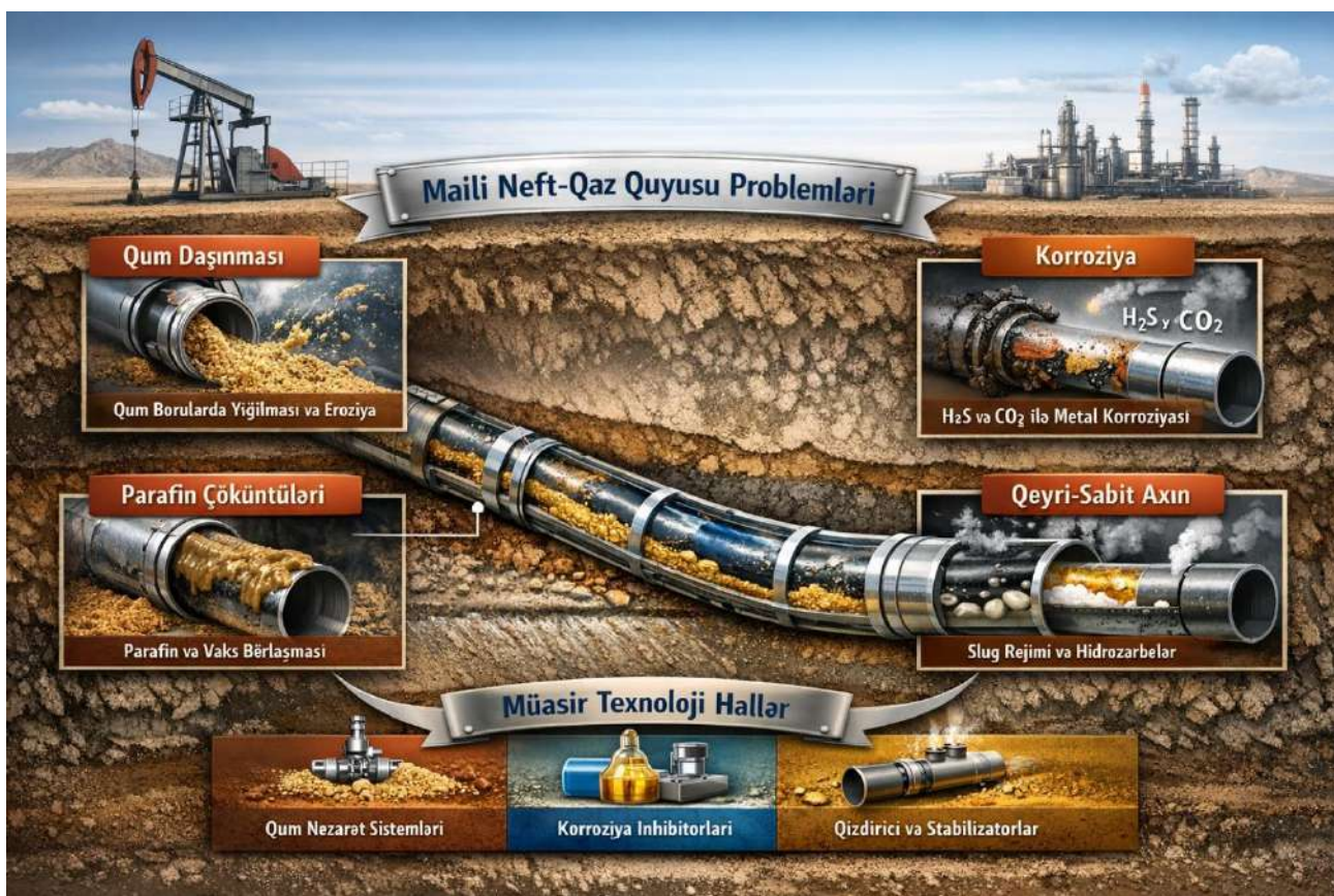
Şəkil 1. Maili neft-qaz quyularında əsas mürəkkəbləşmələr.
